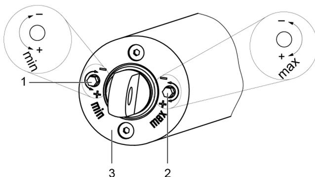
Fig. 4 Tapa con tornillos reguladores
