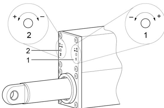
Fig. 3 Couvercle du corps avec vis de réglage
