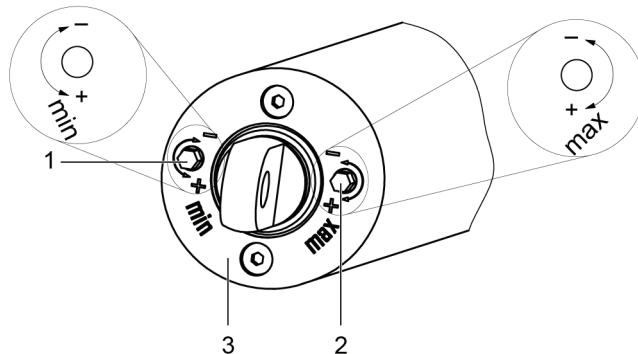
Fig. 4 Tetto con viti di regolazione
