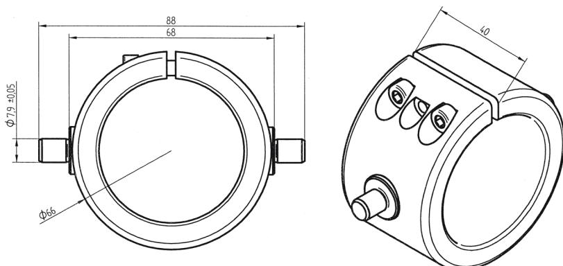
Fig. 2 Fixation pendulaire
