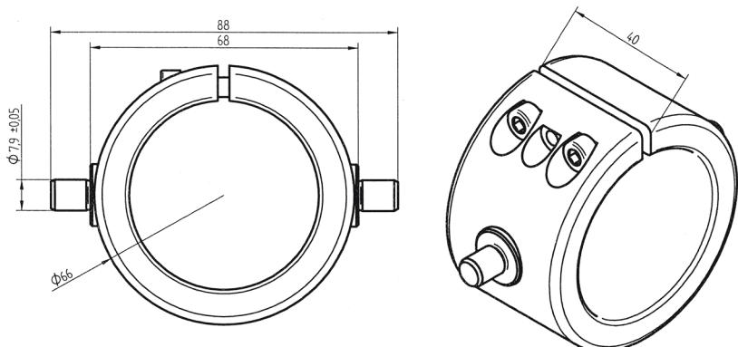
Fig. 2 Fijación por pivote basculante
